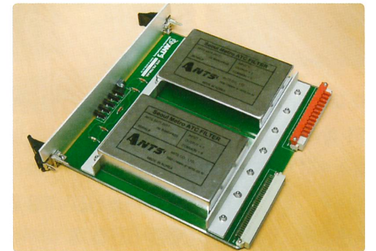
▲ 지상으로부터 전해지는 신호를 신속하고 정확하게 전달해주는 Smart ATC Filter Board
